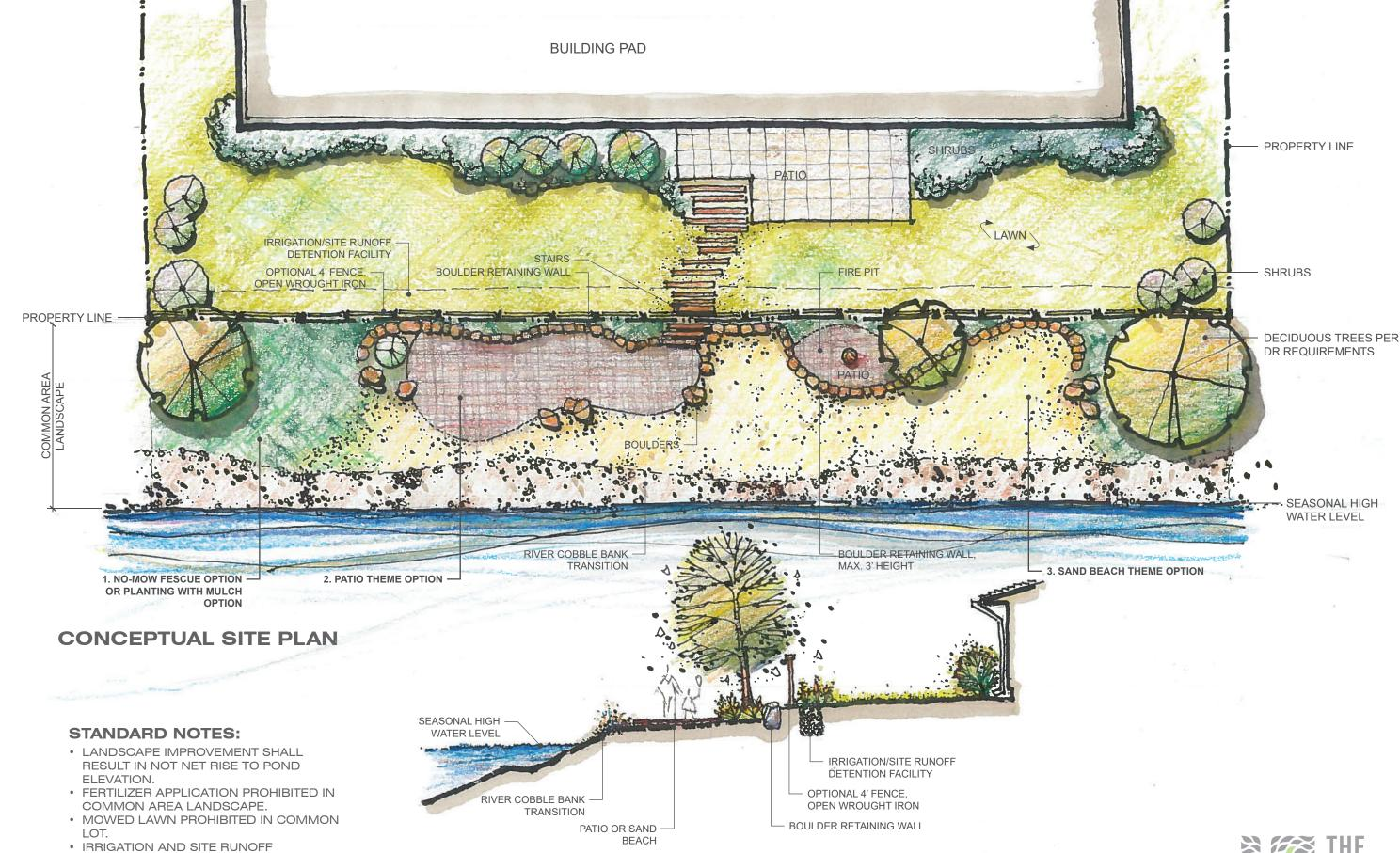
IRRIGATION AND SITE RUNOFF DETENTION FACILITY REQUIRED ON PROPERTY PARVEL AT TOP BANK OF POND SLOPE.
